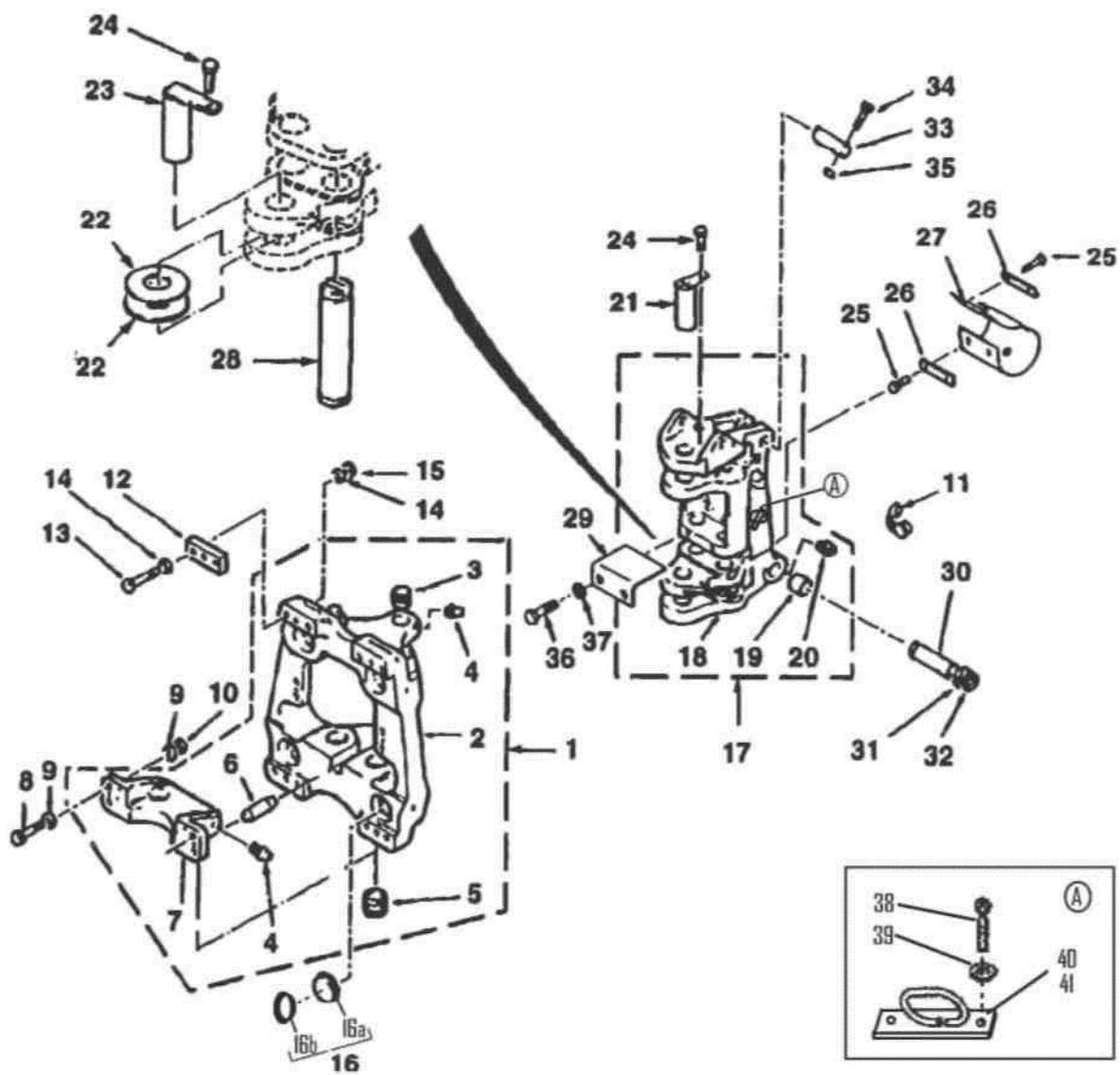
**МЕХАНИЗМЫ ПОВОРОТА, СМЕЩЕНИЯ ЭКСКАВАТОРНОГО ОБОРУДОВАНИЯ**
